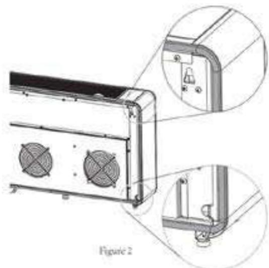
Soulevez l'unité sur le mur, alignez les trous de suspension avec les crochets du rail et reposez doucement l'unité en place. En même temps, faites glisser le tuyau de drainage à travers le trou réalisé précédemment.
