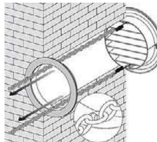
Dépliez le couvercle externe et mettez-le en place. Tendez les chaînes avant de les fixer en les accrochant sur la bague interne. Le couvercle externe sera ainsi maintenu fermement en position.
