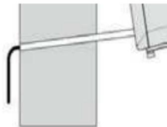
Le trou pour le tuyau de drainage doit être percé à l'aide d'un foret de 25 mm. Veillez à ce que ce trou soit incliné vers le bas (au moins 5 degrés) afin que l'eau s'écoule correctement.
