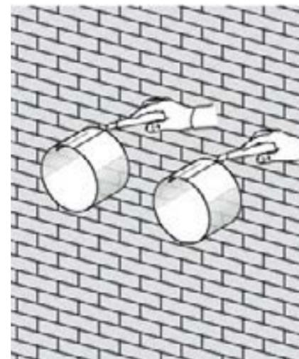
Sortez à l'extérieur et coupez l'excédent du tube à l'aide d'un cutter, en veillant à ce que le bord soit aussi net que possible.
