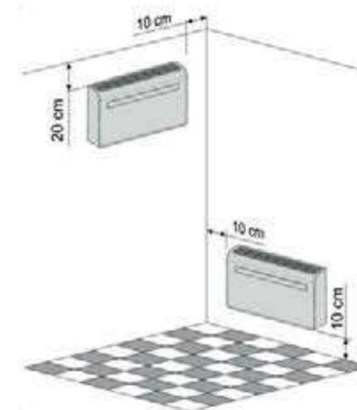
Cet appareil doit être installé sur un mur donnant sur l'extérieur car il ventile directement par l'arrière.
