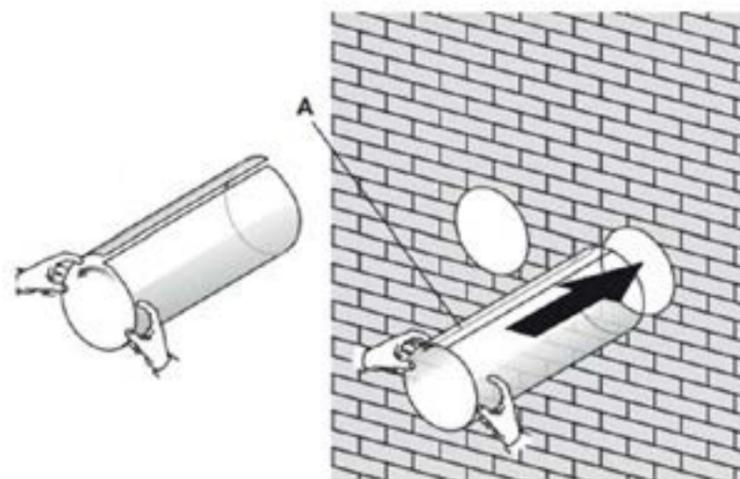
Rouler les feuilles des conduits de ventilation en plastique fournies en forme de tube et insérez-les à l'intérieur des trous réalisés précédemment.
