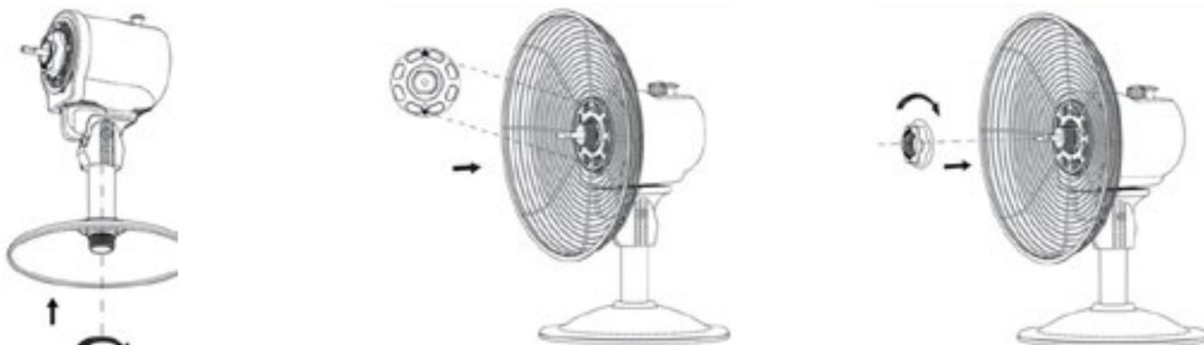
Insérez les pales du ventilateur (3) sur l'axe du moteur (11). Vissez la vis de maintien des pales (3).
