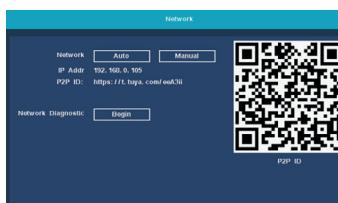
Configuração 4: configurações de rede. Você pode escolher obter automaticamente um endereço IP, definir manualmente o endereço IP e operações de diagnóstico de rede. A interface de operação é como mostrado na figura abaixo. Após a conclusão da operação, clique em Avançar para continuar a configuração do assistente. Se precisar retornar à Configuração 3, selecione a etapa anterior.
