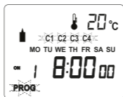
Mise en route du mode programmation
