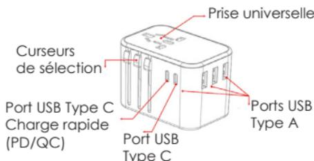
La sortie maximale totale du chargeur est de 33,5 W, le port PD / QC est de 18 W et le maximum des 3 ports USB et USB-C est de 15,5 W. Si plusieurs appareils se chargent en même temps à plus de 33,5 W, retirez simplement un appareil et chargez-le individuellement. Remarque : le courant nominal total de 3 ports USB est de 3,1 A maximum.
