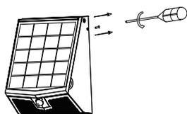
1. Retirez les vis sur le côté de la plaque de montage. Retirez la plaque de montage de la lampe
