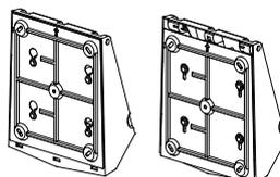
2. Faites glisser la plaque de montage vers le bas jusqu'à la position d'évacuation et retirez-la facilement.
