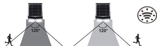
La lumière principale s'allume automatiquement à pleine intensité 700LM (lumière de lavage de la paroi du bas éteinte) lorsqu'un mouvement est détecté à une distance de 8 mètres, la lumière de lavage de la paroi du bas 5 s'allume automatiquement (lumière principale éteinte) au bout de 20 secondes sans mouvement.
