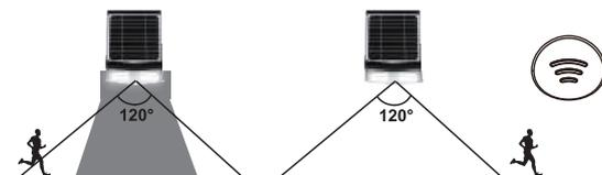
La lumière principale s'allume automatiquement à pleine intensité 700LM (lumière de lavage de la paroi du bas éteinte) lorsqu'un mouvement est détecté à une distance de 8 mètres et s'éteint après 20 secondes sans mouvement.
