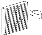
Percez 5 trous de 8mm avec une profondeur de 60-65mm sur le mur.
