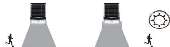
S'allume automatiquement au crépuscule et garde une luminosité de 50% en permanence. (détecteur de mouvement désactivé). Après 5 heures ou lorsque la capacité de la batterie est inférieure à 30%, elle passera au mode ▼.
