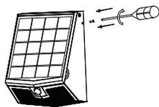
Fixez la vis sur le côté de la plaque de montage.
