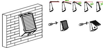
Desserrez les vis des deux côtés de la lampe. Réglez le panneau solaire selon un angle convenable, puis fixez les vis des deux côtés de la lampe.
