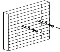
Utilisez un tournevis pour fixer la plaque de montage sur le mur avec des vis
