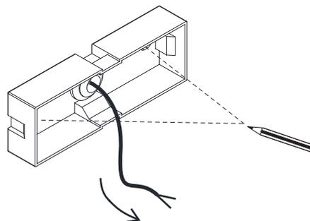
1. A l'aide du support de l'applique, marquer la position des trous au mur à l'aide du support de l'applique
