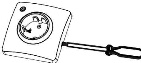
2. Effectuez la connexion de votre prise encastrée wifi dans le respect des polarités électriques. Fixez la prise encastrée dans le mur et refermez-la à l'aide des vis correspondantes. Replacez la plaque sur la prise encastrée.
