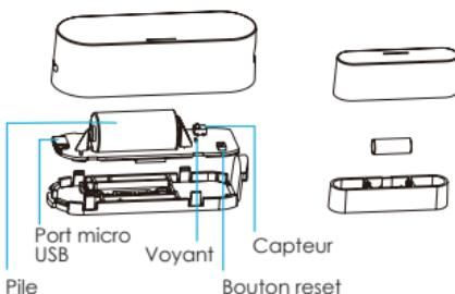
L'alimentation de votre détecteur d'ouverture TRIGG-E se fait par pile CR123A ou par alimentation 5V / 1A.
